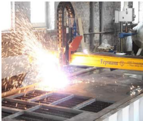
Плазменная резка Цифровое управление. Толщина листа: 5 – 35 мм.
