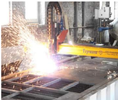
Плазменная резка Цифровое управление. Толщина листа: 5 – 35 мм.
