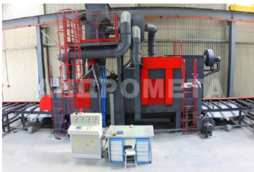
Дробеструйная обработка Стальная дробь \varnothing 0,8..1,0 мм Класс чистоты Sa 2.5
