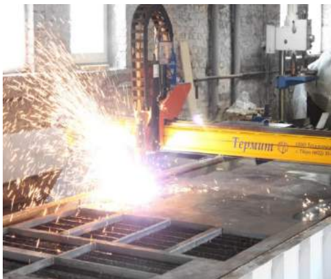
Плазменная резка Цифровое управление. Толщина листа: 5 – 35 мм.
