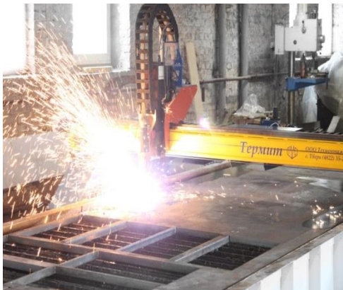
Плазменная резка Цифровое управление. Толщина листа: 5 – 35 мм.
