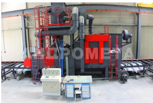
Дробеструйная обработка Стальная дробь Ø0,8..1,0 мм Класс чистоты Sa 2.5
